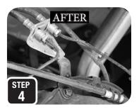
$\triangle$  THE LIFT BLOCK MUST BE INSTALLED WITH THE SHORT SIDE FORWARD AND THE TALL SIDE FACING THE REAR OF THE TRUCK.  $\triangle$  THE LEAF SPRING CENTER PIN MUST BE INSTALLED IN THE OFF-CENTER HOLE OF THE BLOCK TO CORRECT FOR DRIVE SHAFT PLUNGE OUT OF THE TRANSMISSION.  $\triangle$
