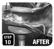
DUST CAP ON THE BACK OF THE WHEEL BEARING FOR CLEARANCE.
